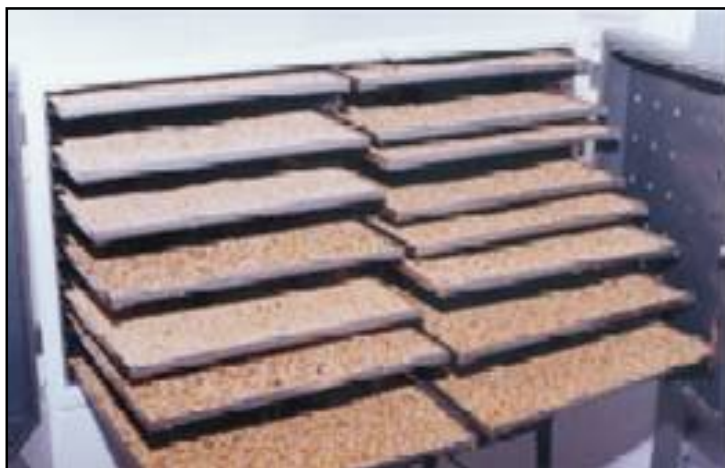
FIGURA 8 - ESTUFA SECADORA DE PÓLEN APÍCOLA FONTE: MAGALHÃES, 2005.
